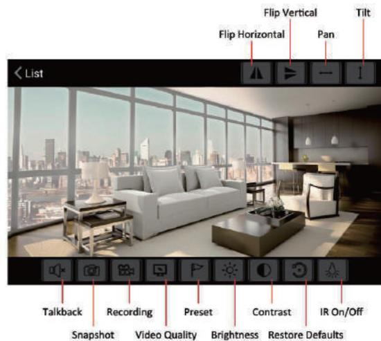
**Achtung:** Für PT-Kameras, können Sie schwenken und die Kamera kippen,durch gleiten auf dem Bildschirm des Telefons .
