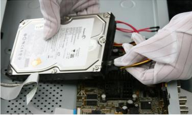
Fase 4: Posizionare il disco rigido sulla parte inferiore del dispositivo e quindi fissare le viti sul fondo per fissare il disco rigido.
